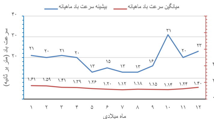
شکل ۱۴- میانگین ماهیانه سرعت باد و بیشینه سرعت باد برای ماه‌های میلادی در شهر رشت.
